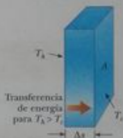
Figura 20.10 Transferencia de energía a través de una placa conductora con área A de sección transversal y grosor \Delta x . Las caras opuestas están a diferentes temperaturas T_c y T_h .
