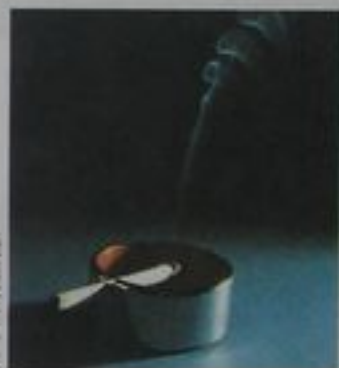
Figura 14.15 Gases calientes de un cigarrillo hechos visibles por partículas de humo. El humo se mueve primero en flujo laminar en la parte baja y luego en flujo turbulento arriba.
