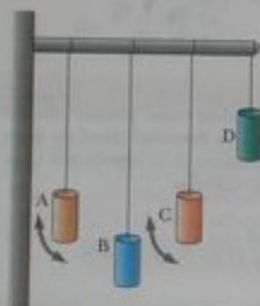
Figura 18.15 Ejemplo de resonancia. Si el péndulo A se pone en oscilación, sólo el péndulo C, cuya longitud es igual a la de A, oscila finalmente con amplitud grande, y resuena. Las flechas indican movimiento en un plano perpendicular a la página.
