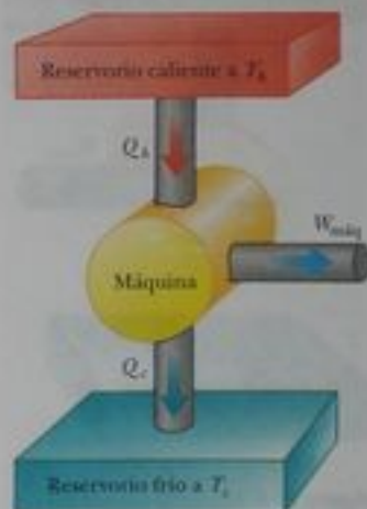
Figura activa 22.2 Representación esquemática de una máquina térmica. La máquina realiza trabajo W_{\text{máq}} . La flecha de la parte superior representa energía Q_h > 0 que entra a la máquina. En la parte inferior, Q_c < 0 representa energía que sale de la máquina.
