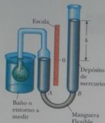
Figura 19.4 Un termómetro de gas de volumen constante mide la presión del gas contenido en el frasco inmerso en el baño. El volumen de gas del frasco se mantiene constante al elevar o bajar el depósito B para mantener constante el nivel de mercurio en la columna A.
