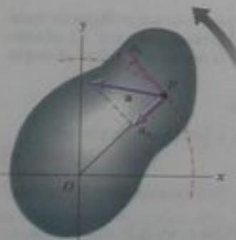
Figura 10.5 Cuando un cuerpo rígido rota alrededor de un eje fijo que pasa por O , el punto P experimenta un componente tangencial de aceleración lineal a_t y un componente radial de aceleración lineal a_r . La aceleración lineal total de este punto es \mathbf{a} = \mathbf{a}_t + \mathbf{a}_r .
