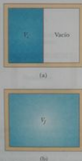
Figura 22.17 En una expansión libre, el gas se deja expandir entrando en una región a la que previamente se hizo vacío.
