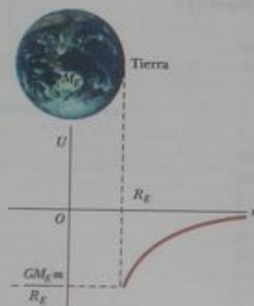
Figura 13.13 Gráfica de la energía potencial gravitacional U contra r para un cuerpo arriba de la superficie de la Tierra. La energía potencial se va a cero cuando r se aproxima al infinito.
