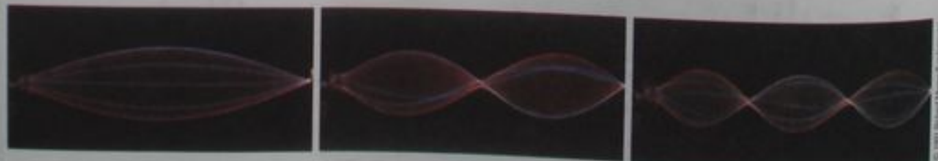
Fotografías de destellos múltiples de figuras de onda estacionaria en una cuerda excitada por un vibrador en su extremo izquierdo. La figura de un solo lazo representa el primer modo normal (la fundamental, n = 1 ). La figura de doble lazo representa el segundo modo normal ( n = 2 ), y la figura de tres lazos representa el tercer modo normal ( n = 3 ).
