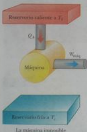
Figura 22.4 Diagrama esquemático de una máquina térmica que toma energía de un reservorio caliente y realiza una cantidad equivalente de trabajo. Es imposible construir tal máquina perfecta.
