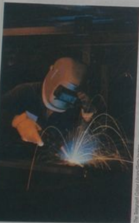
Un soldador corta agujeros en una pesada viga metálica de construcción con un soplete. Las chispas generadas en el proceso siguen trayectorias parabólicas.
