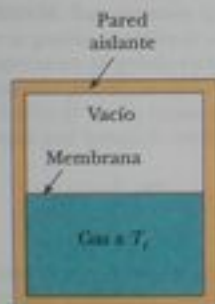
Figura 22.16 Expansión libre adiabática de un gas. Cuando la membrana que separa el gas de la región al vacío se rompe, el gas se expande libre e irreversiblemente. En consecuencia, ocupa un mayor volumen final. El recipiente está térmicamente aislado de su entorno; por lo tanto, Q = 0 .
