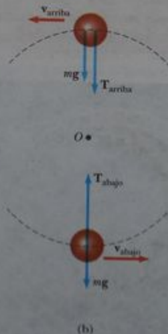
Figura 6.10 (a) Fuerzas que actúan sobre una esfera de masa m conectada a una cuerda de longitud R que gira en un círculo vertical centrado en O . (b) Fuerzas que actúan sobre la esfera en la parte alta y baja del círculo. La tensión es máxima en la parte baja y mínima en la parte alta.
