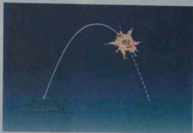
Figura 9.26 (Ejemplo conceptual 9.17) Cuando un proyectil explota en varios fragmentos, el centro de masa del sistema formado por todos los fragmentos sigue la misma trayectoria parabólica que el proyectil hubiera tomado si no hubiera habido explosión.
