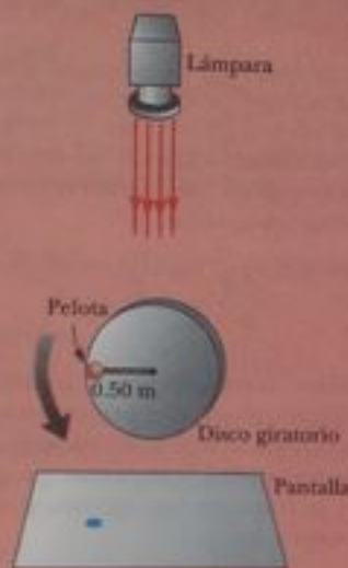
Figura 15.16 (Pregunta rápida 15.6) Un cuerpo se mueve en movimiento circular, proyectando una sombra sobre la pantalla abajo. Se muestra su posición en un instante del tiempo.
