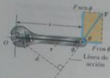
Figura 10.13 La fuerza F tiene mayor tendencia a la rotación alrededor de O cuando aumenta F y cuando aumenta el brazo de momento d . El componente F \sin \phi tiende a hacer girar la llave alrededor de O .
