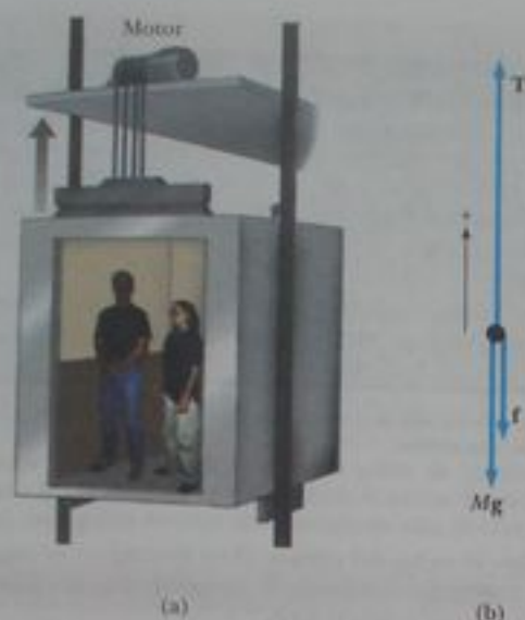
Figura 7.19 (Ejemplo 7.12) (a) El motor ejerce una fuerza T hacia arriba sobre el elevador. La magnitud de esta fuerza es la tensión T del cable que conecta el elevador y motor. Las fuerzas hacia abajo que actúan sobre el elevador son una fuerza f de fricción y la fuerza gravitacional F_g = Mg . (b) Diagrama de cuerpo libre para el elevador.
