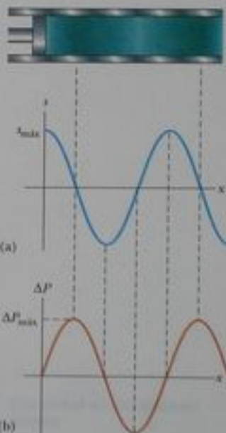
Figura 17.3 (a) Amplitud de desplazamiento y (b) amplitud de presión contra posición para una onda longitudinal senoidal.
