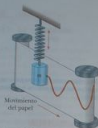
Figura 15.3 Aparato experimental para demostrar el movimiento armónico simple. Una pluma sujeta al cuerpo oscilante marca una forma sinusoidal sobre el papel de gráfica en movimiento.
