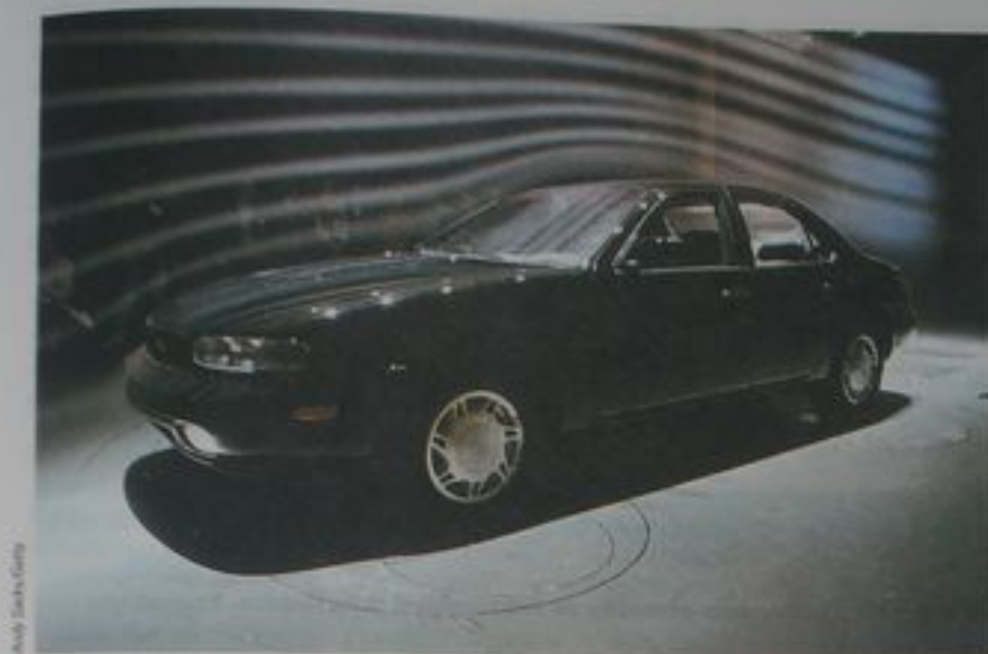
Figura 14.14 Flujo laminar alrededor de un automóvil en un túnel de viento para pruebas.
