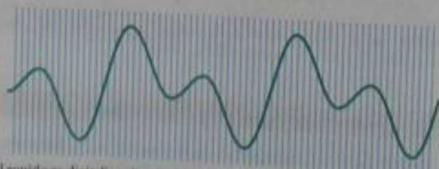
Figura 17.13 El sonido se digitaliza al muestrear electrónicamente la onda de sonido a intervalos periódicos. Durante cada intervalo de tiempo entre las líneas azules, un número se registra para el voltaje promedio durante el intervalo. La rapidez de muestreo que aquí se presenta es mucho más lenta que el ritmo real de 44 100 muestras por segundo.
