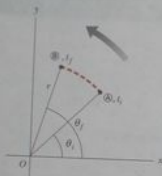
Figura 10.2 Una partícula en un cuerpo rígido en rotación se mueve de \textcircled{A} a \textcircled{B} a lo largo del arco de un círculo. En el intervalo \Delta t = t_f - t_i , el radio vector barre un desplazamiento angular \Delta\theta = \theta_f - \theta_i .
