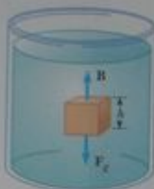
Figura 14.8 Las fuerzas que actúan sobre el cubo de líquido son la fuerza gravitacional F_g y el empuje hidrostático B . Bajo condiciones de equilibrio, B = F_g .
