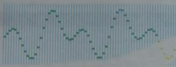
Figura 17.15 Reconstrucción de la onda de sonido muestreada en la figura 17.13. Nótese que la reconstrucción es por pasos, más que la onda continua de la figura 17.13.
