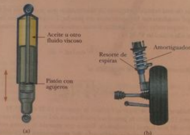
Figura 15.24 (a) Un amortiguador consta de un pistón que oscila en una cámara llena de aceite. Cuando oscila el pistón, el aceite sale por agujeros entre el pistón y la cámara, causando un amortiguamiento de las oscilaciones del pistón. (b) Un tipo de sistema de suspensión de automóvil, en el que un amortiguador se coloca dentro de un resorte de espiras en cada rueda.
