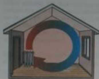
Figura 20.15 Se establecen corrientes de convección en un cuarto calentado por un radiador.
