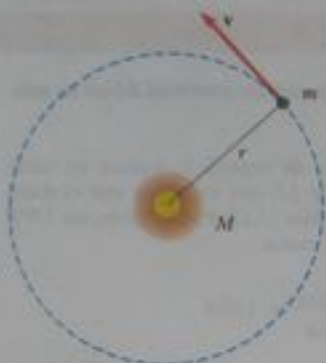
Figura 13.15 Cuerpo de masa m que se mueve en órbita circular alrededor de un cuerpo mucho más grande de masa M .
