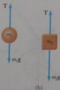
Figura 5.14 (Ejemplo 5.9). Máquina de Atwood. (a) Dos objetos ( m_2 > m_1 ) conectados por una cuerda sin masa y no extensible colocada sobre una polea sin fricción. (b) Diagramas de cuerpo libre para los dos objetos.
