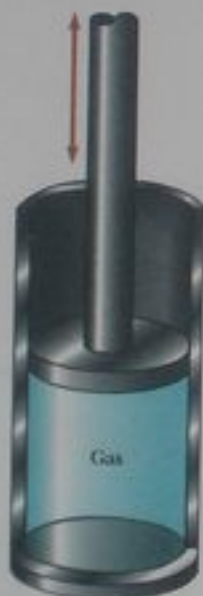
Figura activa 19.12 Gas ideal confinado en un cilindro cuyo volumen puede hacerse variar por medio de un émbolo móvil.
