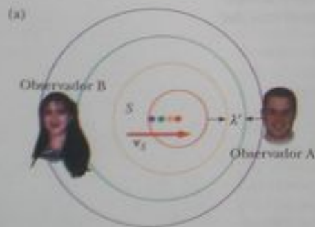
Figura activa 17.9 (a) Una fuente S que se mueve con una rapidez v_S hacia un observador estacionario A y alejándose de un observador estacionario B . El observador A escucha una frecuencia aumentada, y el observador B escucha una frecuencia disminuida. (b) El efecto Doppler en agua, observado en un tanque de ondas. Una fuente puntual se mueve a la derecha con rapidez v_S . Las letras que se ven en la foto se refieren a la Pregunta rápida 17.7.
