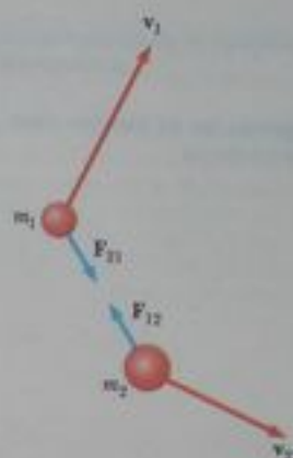
Figura 9.1 Dos partículas interactúan entre sí. Según la tercera ley de Newton, debemos tener \mathbf{F}_{12} = -\mathbf{F}_{21} .
