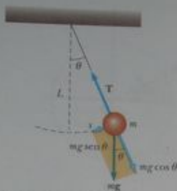
Figura activa 15.17 Cuando \theta es pequeña, un péndulo simple oscila en movimiento armónico simple alrededor de la posición de equilibrio \theta = 0 . La fuerza restauradora es -mg \sin \theta , el componente de la fuerza gravitacional tangente al arco.
